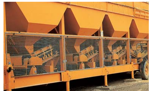
Centrale de graves - pesage des granulats
